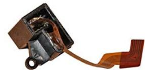
Ces capteurs fabriqués de référence XV-3500 et fabriqués par Epson sont d'une taille nettement inférieure aux ENC-03 utilisés par les premières générations de modules IS. Leur fonctionnement reste identique avec une tension de sortie évoluant autour d'une valeur de référence selon les accélérations angulaires mesurées. L'axe de mesure est vertical par rapport à leur boîtier.
