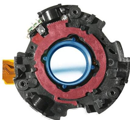
Ce système est réalisé avec une came circulaire (en rouge) venant immobiliser quatre bossages présents sur la lentille mobile (en bleu).
